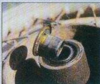
So sieht die Buchse aus, die die Staubkappe festhält und im Betrieb die Achse aufnimmt
