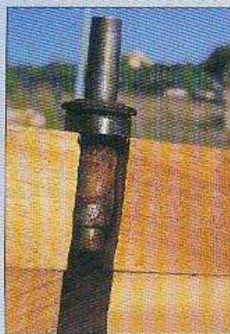
Die Kanthölzer dienen hier als Stütze des Lagers, aus dem die Buchse ausgeschlagen wird
